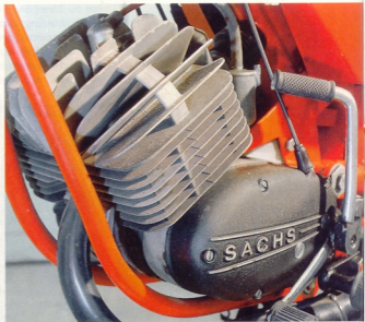
Der legendäre Fächerkopf: Ab 1970 bestückte Hercules seine Kleinkraftäder mit dem 6,25-PS-F&S-Motor, der die Fußziffer auf 100 km/h brachte
