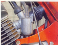
Bing, was sonst? Der 19er Vergaser wick 1979 einer Gasfabrik mit 20 Millimeter Durchlass
