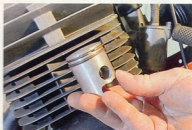
Nur noch als Reproduktion zu bekommen – in unterschiedlichen Qualitäten: der Kolben
